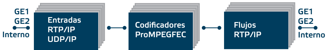
Diagrama de bloques, módulo codificador ProMPEG FEC
