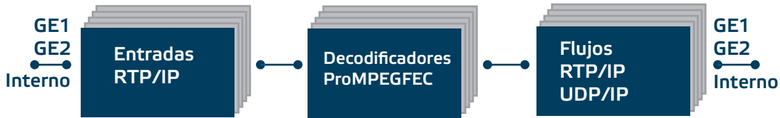
Diagrama de bloques, módulo decodificador ProMPEG FEC
