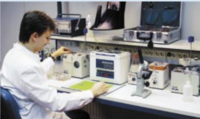
▲ Aluksi kaikki kuituhitsaukset ja liittimien liimaus sekä hionta tehtiin itse omassa kuitulaboratoriossa. Kuituteknikka oli tuolloin vielä tarkkuutta vaativaa käsityötä. Oikealla kuva tuotannon kokoonpanolinjalta.
