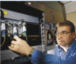
▲ Aluksi kaikki kuituhitsaukset ja liittimien liimaus sekä hionta tehtiin itse omassa kuitulaboratoriossa. Kuituteknikka oli tuolloin vielä tarkkuutta vaativaa käsityötä. Oikealla kuva tuotannon kokoonpanolinjalta.
