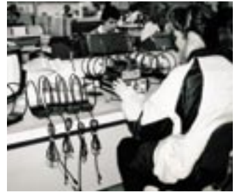
Super Loop-antennin kokoonpanoa Ealyn tehtaalla. Antennissa oli Teosten ensimmäinen tilausmikropiiri (ASIC), joka "haistoi" oliko TV toiminnassa ja kytki antennivahvistimen toimintaan TV:n olessa päällä.
